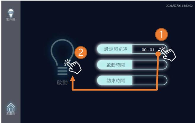
▲ 首先設定紫外燈開啟時間長度，接著點選燈泡圖示開始紫外燈照射
