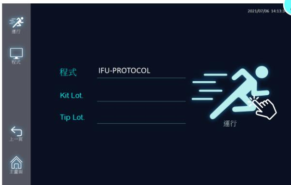
▲ 輸入試劑與旋轉套批號為可忽略步驟，但我們強烈建議您輸入，以利後續試驗追蹤。結束輸入後，快速點擊兩次運行圖示以進行下一步。
