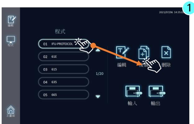
▲ 请先选好您欲“贴上”的目标字段，接着点选欲复制的程序，再按下复制
