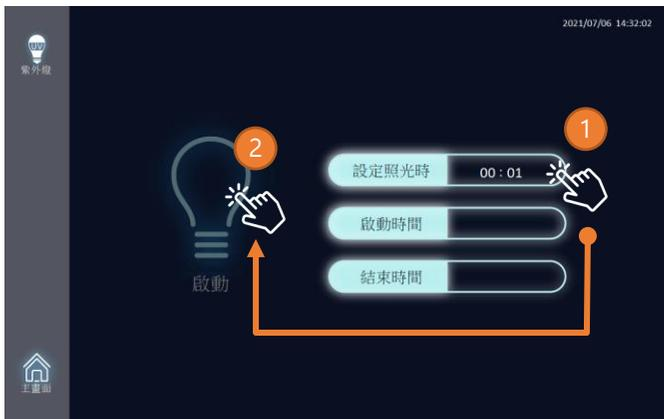
▲ 首先设定紫外灯开启时间长度，接着点选灯泡图示开始紫外灯照射
