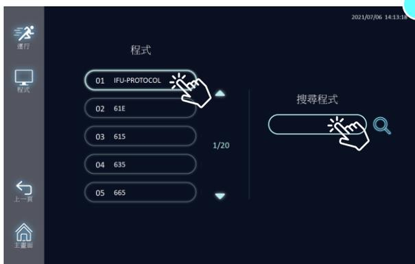
▲ Maelstrom 4810能够储存高达100组程序。请参造试剂使用说明指定程序。如程序较多，可点选搜寻字段进行搜寻缩短寻找时间。
